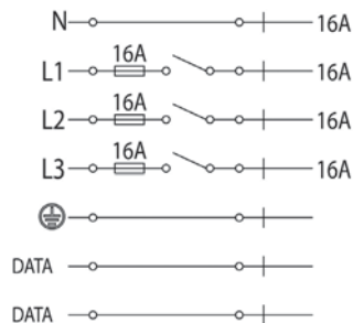
SCHEMA ELETTRICO TRIFASE A TENSIONE DI RETE 230/250V. THREE-PHASE ELECTRIC DIAGRAM FOR MAINS VOLTAGE 230/250V.
